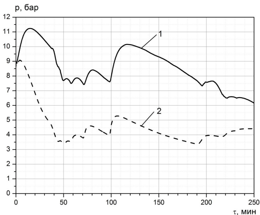
Рис. 4.42. Зависимость давления в свободном объеме аккумулятора от времени. 1 – экспериментальные данные ОИВТ РАН[8], 2 – результаты расчета
